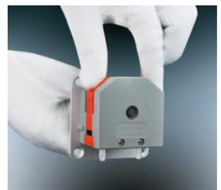
4. 将上压块顺滑槽压入泵头，并确保落位。
