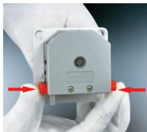
2. 确保软管置于滚轮中央，再将管卡推入泵头。
